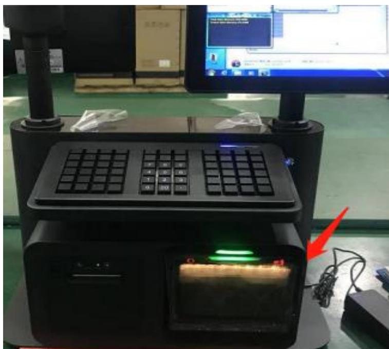
2. 拧下走线挡板的螺丝，打开挡板；
