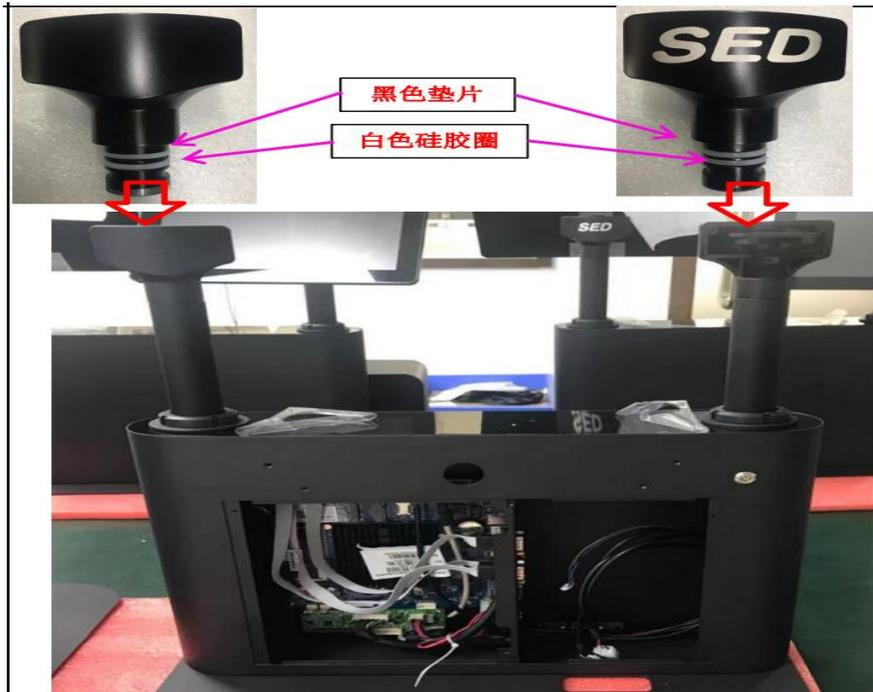
4. 取扳手将立柱固定螺丝拧松，拆下机壳上一个圆形止动螺母，再从机箱里面取出防松垫片+圆形止动螺母；
